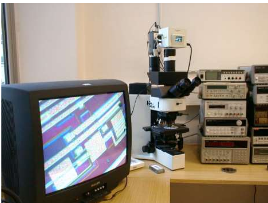
Pracoviště s optickým mikroskopem pro charakterizaci IO a MEMS struktur Laboratoř Centrum mikrosystémů CEMIS.
