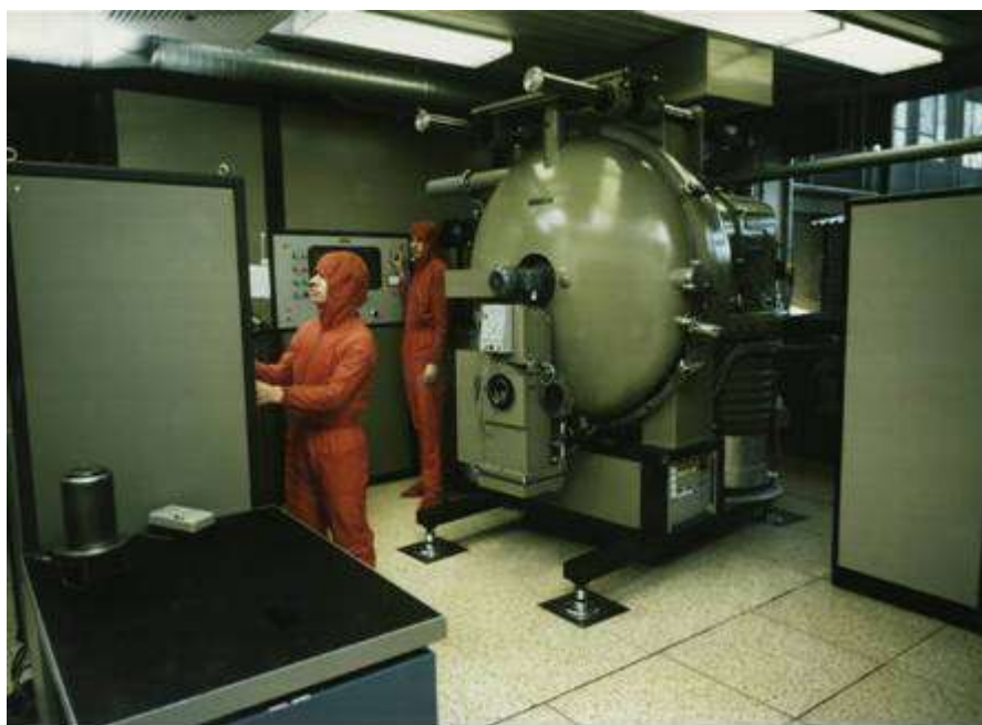
Implantace na implantátoru SCI-18 SCANIBAL (M. Pišna, T. Vrba)
