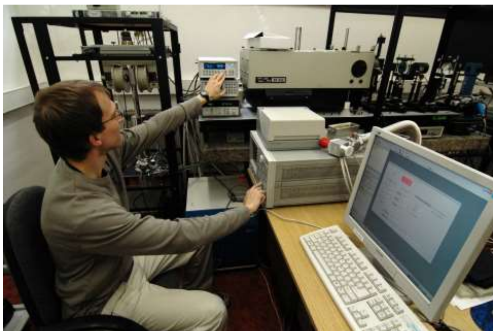
Měření magnetoelektrických vlastností spintronických nanostruktur při nízkých teplotách. 2D struktury na bázi GaMnAs jsou vytvořeny technikou MBE a dále tvarovány AFM nanolitografií.
