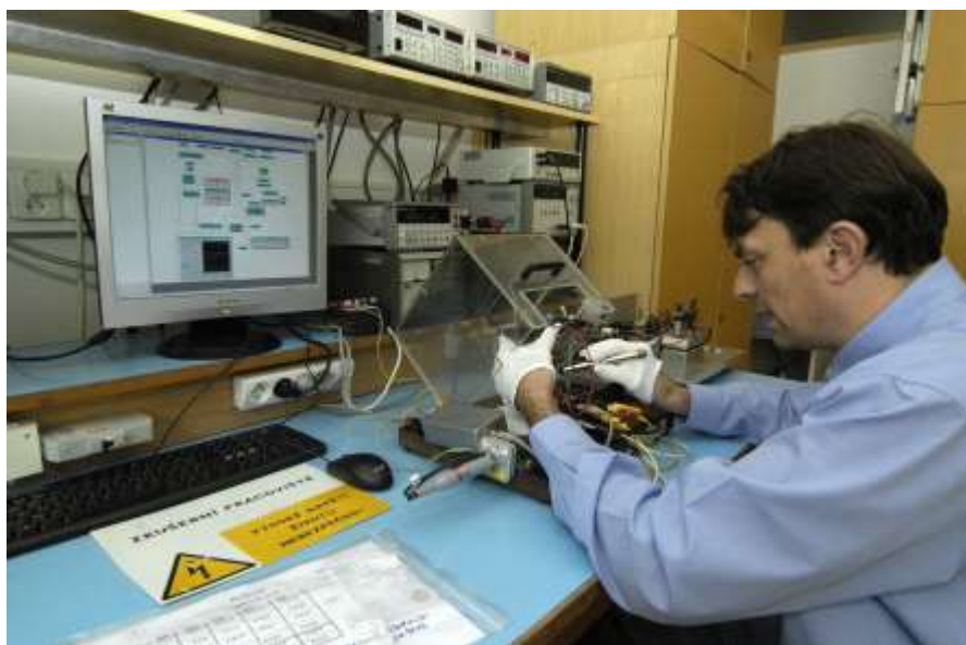
Pracoviště pro měření blokovacích V-A charakteristik výkonových polovodičových struktur v napěťovém rozsahu do 5 kV a při teplotách do 150 °C .
