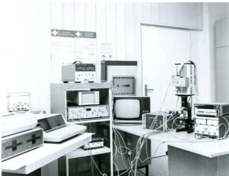
Pracoviště pro automatizované měření intenzity infračerveného rekombinačního záření z křemíkových výkonových struktur ve statickém režimu pomocí vidikonu.
