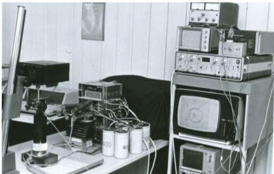
Aparatura pro měření rekombinačního záření z plochy výkonové součástky.
