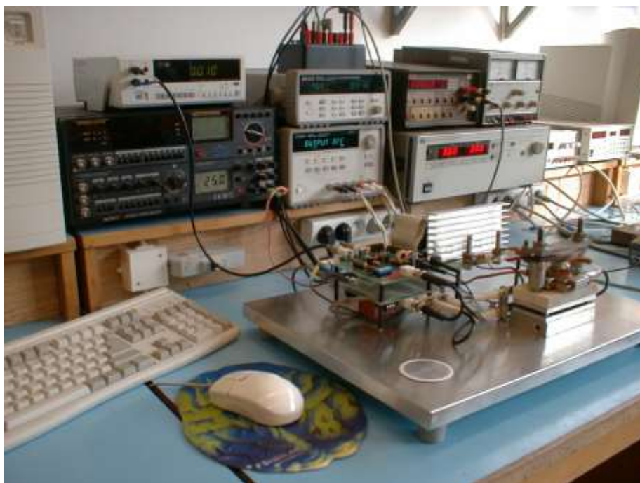
Pracoviště pro charakterizaci propustných V-A charakteristik výkonových polovodičových struktur v rozsahu proudů do 4 kA a při teplotách do 150 °C.
